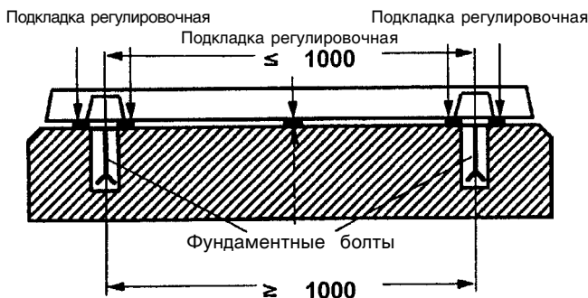
Рис. 5 Размещение регулировочных подкладок
